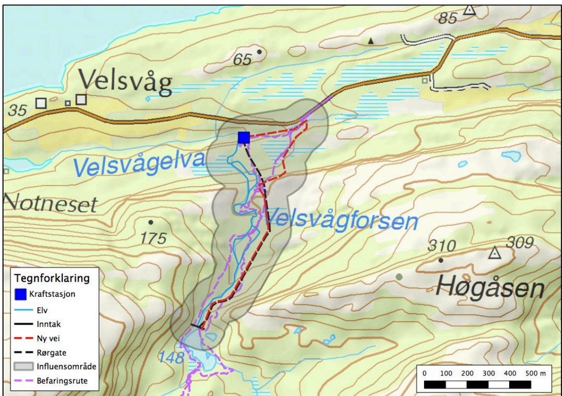
Figur 2. Kart over de viktigste installasjoner i forbindelse med tiltaket. Influensområdet (skravert) i henhold til tommelfingerregelen om at en sone på ca. 100 meter langs berørte elvestrekninger og fysiske inngrep blir berørt.
